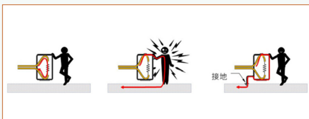
圖2 | 保安接地示意圖
